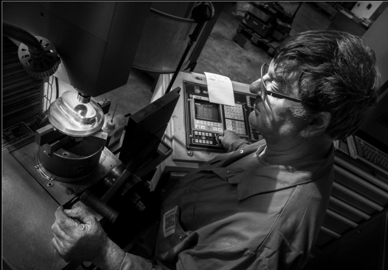
Perçage de trous de petit diamètre (0,7 mm) pour permettre l'aspiration du verre en fusion dans les différentes parties du moule.
